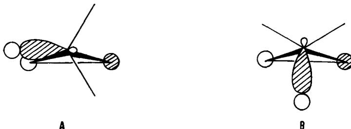
In A findet optimaler Ladungstransfer aus  $\pi^*$  in das dazu parallele antibindende  $\sigma^*$ -Orbital statt. Mit zunehmendem Herausdrehen der Bindung aus der Ebene wird die Überlappung zwischen  $\pi^*$  und  $\sigma^*$  und damit der bindungsschwächende Ladungstransfer kleiner, um schließlich in B ganz zu verschwinden. Dementsprechend hat die senkrecht zur Ringebene stehende Bindung in B die gleiche Stärke wie in einem ungestörten Cyclopropan.
